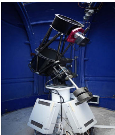
Fig.2 - Il telescopio del CosmoGrAG: un Newton da 12"/30 cm con apertura focale F3, installato su montatura equatoriale in grado di sostenere e gestire un carico fino a 50 kg. Camera APS-H da 9,2 megapixel e pixel di 7,4 micron, filtri fotometrici BVRI Johnson Cousins, focheggiatore elettronico con risoluzione di 0,01 micron.
